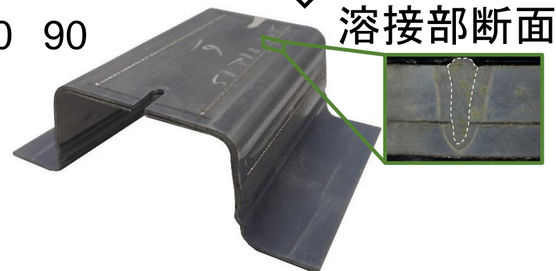
レーザー溶接した成形品
