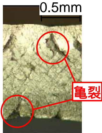
(b) フランジ成形後 (フランジ長さ18mm)
