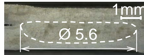
上板: 1.5 GPa級 溶接部断面
