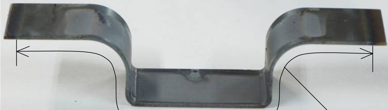
全面加熱 ( Q = 18\text{kJ} )
