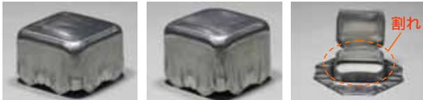
(a) L=80.0mm(絞り高さ25.2mm) (b) L=85.0mm(絞り高さ28.3mm) (c) L=87.4mm(絞り高さ29mm相当)
