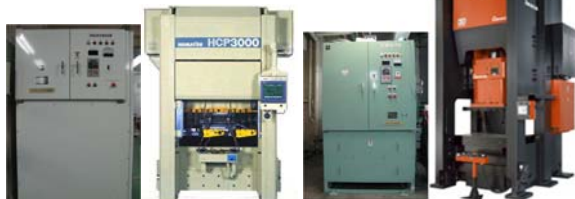
通電電源 サーボプレス 通電電源 サーボプレス
