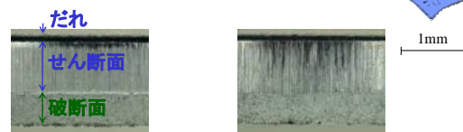
せん断クリアランス比 c=12\% (a) 390MPa材
