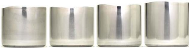
(a) 加工前 (b) SKD11 (c) サーメット (d) TiCコーティングされた超硬
