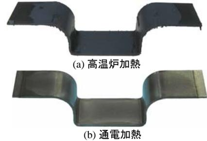
成形とクリアランスなし熱間抜残し加工
