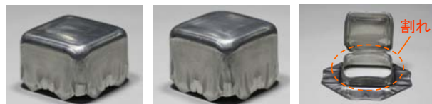
(a) L=80.0\text{mm} (絞り高さ25.2mm) (b) L=85.0\text{mm} (絞り高さ28.3mm) (c) L=87.4\text{mm} (絞り高さ29mm相当) 局部増肉ブランク
