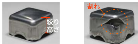
(a) L=75\text{mm} (絞り高さ21.3mm) (b) L=80\text{mm} (絞り高さ23.8mm相当) 均一肉厚ブランク
