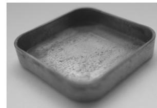
図 17 2 段プレス成形された角筒容器
