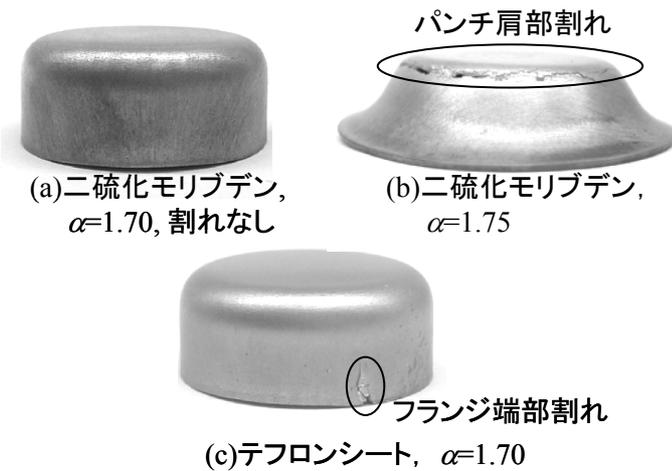
図6 潤滑剤による割れ形態の変化
