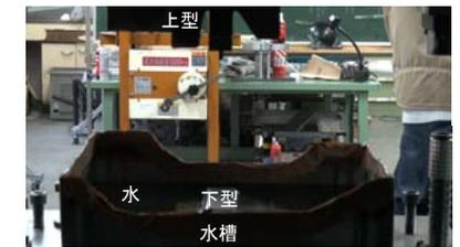
ホットスタンピング中のトリミングおよび穴抜き加工
