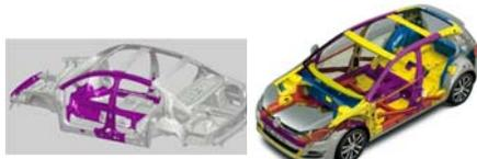
パサート: 骨格部材の17% (2006年)      ゴルフ: 骨格部材の28% (2012年, 23kgの軽量化)
