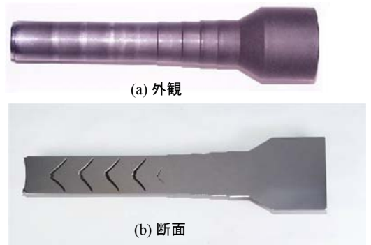
図 多段押し出し加工におけるシェブロンクラック
