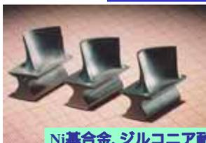
Ni基合金, シルコニア耐熱・断熱性皮膜など
