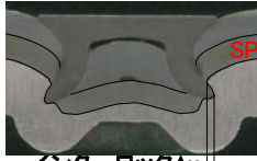
(c) 高張力鋼板とアルミ合金板(上板, 中板=1mm, 下板=2.5mm)
