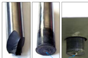
ピンの破壊 (a), (b) 工具鋼 (c) 超硬合金
