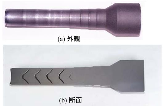
図 多段押し出し加工におけるシェブロンクラック
