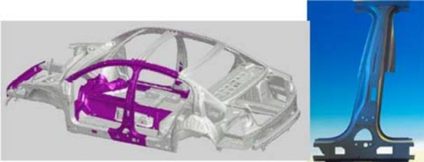
フォルクスワーゲン パサート, 骨格部材の16%が熱間プレス成形
