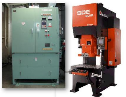
通電加熱電源+クランク式サーボプレス
